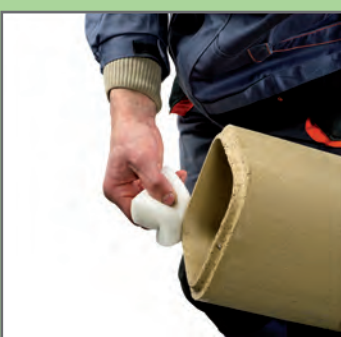
8. Oczyszczyć pióro-wpust wilgotną gąbką
