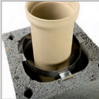
7. Stosować opaski: przy \varnothing 120-200 – 1 szt. na 1 mb ceramiki, przy \varnothing 250-300 – 1 szt. na 1,5 mb ceramiki oraz na każde podłączenie kotła i wyczystkę.
